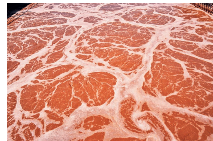
Die Planctomyceten Bakterien sorgen für eine deutliche Rotfärbung im Becken der Prozesswasserbehandlung.
